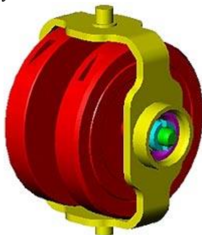
Модель ГК с цельнометаллическим карданным подвесом.
