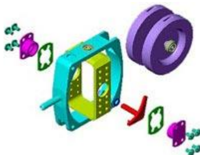
Конструкция ГК с составным подвесом.
